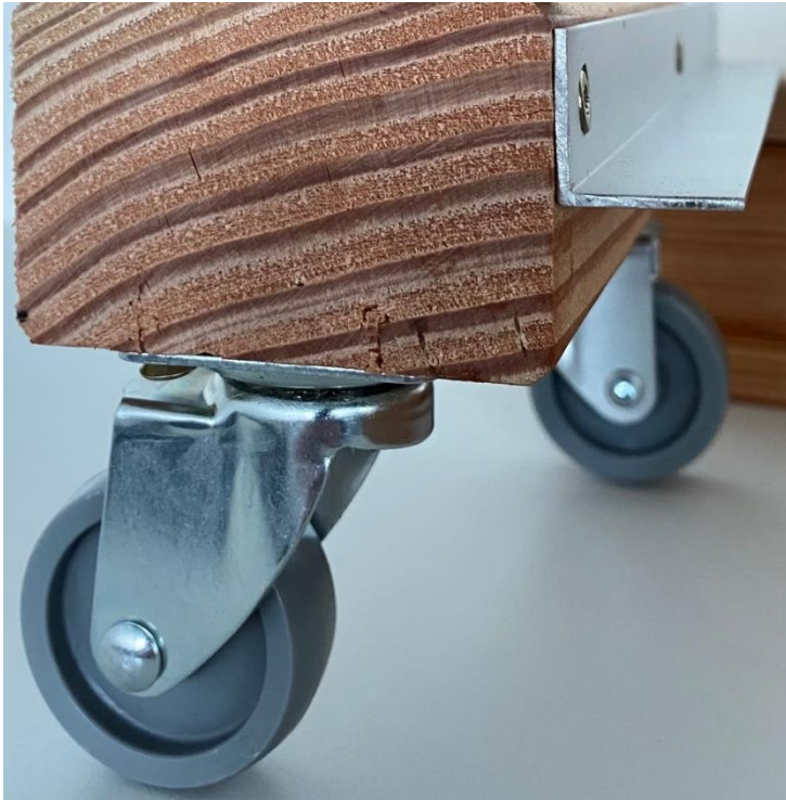
Abbildung 2: Winkelprofile und Rollen an den Kanthölzern des Bodens (Schritt 4)
