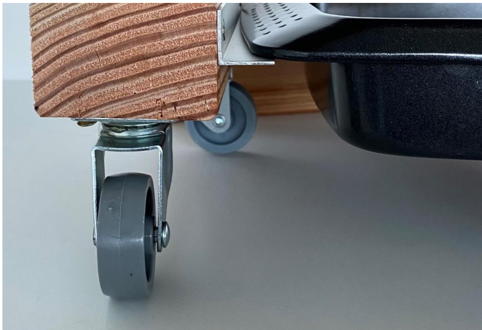
Abbildung 3: Winkelprofile und Rollen an den Kanthölzern des Bodens (Schritt 4)
